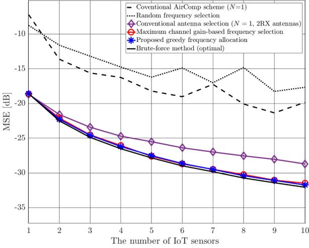
그림 2. 제안하는 주파수 효율적 AirComp 시스템의 MSE 성능.
