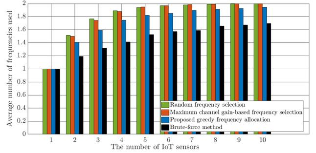
그림 3. 제안하는 주파수 효율적 AirComp 시스템의 평균 주파수사용량.
