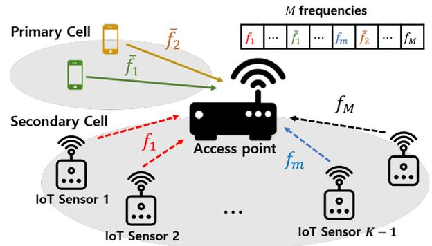
그림 1. Cognitive Radio 기반 AirComp 시스템 모델
